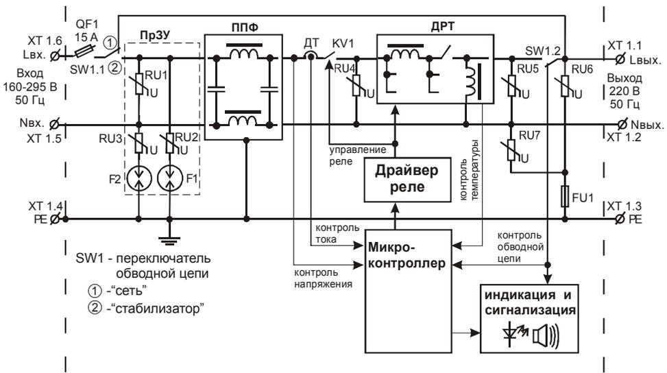
Рисунок 2 – Упрощённая структурная схема стабилизатора
